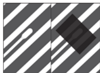
9. Установка датчика температуры на нагревательной пленке.
