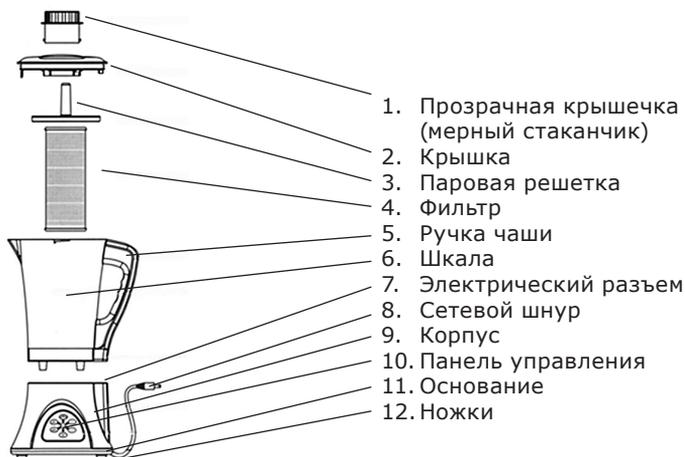
2. Установите Суповарку на ровную, сухую поверхность. Установите чашу на корпус устройства так, чтобы контакты на ней совпали с контактами на корпусе (выступ на корпусе должен войти в выемку под ручкой чаши)
